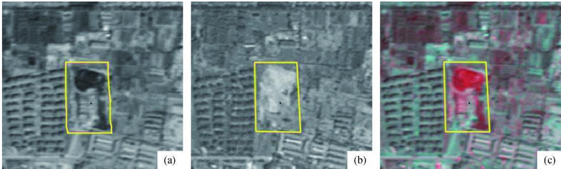
图 5 全色波段彩色合成法变化检测 (a)2006-04-22 全色影像; (b) 2006-09-13 全色影像; (c) 全色波段合成变化图
